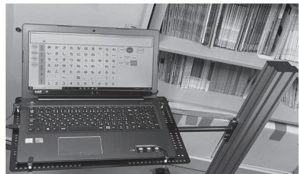
図 1 症例の OriHime Eye の構成 (架台に取付)
