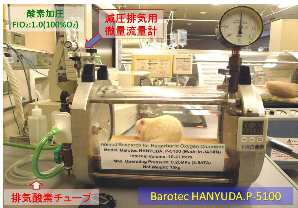
図 2. 動物実験用 HBO 装置の外観と 2.5 ATA で処置を受ける I/R +HBO ラット 装置換気量は収容した動物の呼気 CO 2 の再呼吸を来さない程度に加圧ガス量を調整した。
